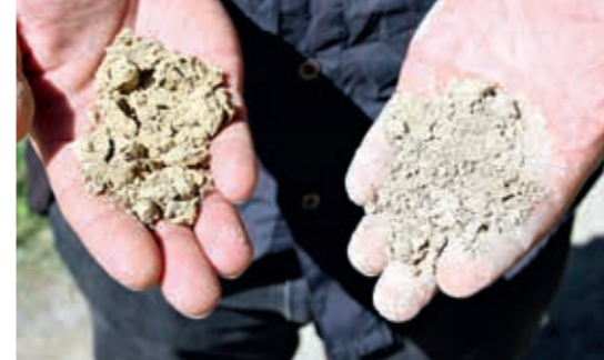
Optisch kaum zu unterscheiden: Kalk und Kalk-Asche-Gemisch
