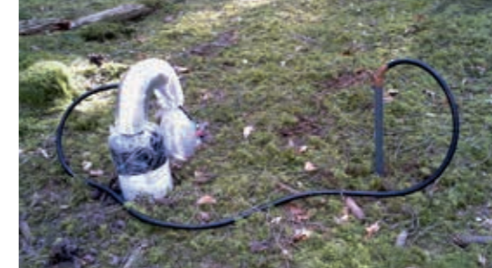
Probe-Entnahme-Punkt mit Saugkerzenanlage: Über eine große Flasche wird Unterdruck erzeugt, um das Bodenwasser zu extrahieren. Foto: Dr. Peter Hartmann
